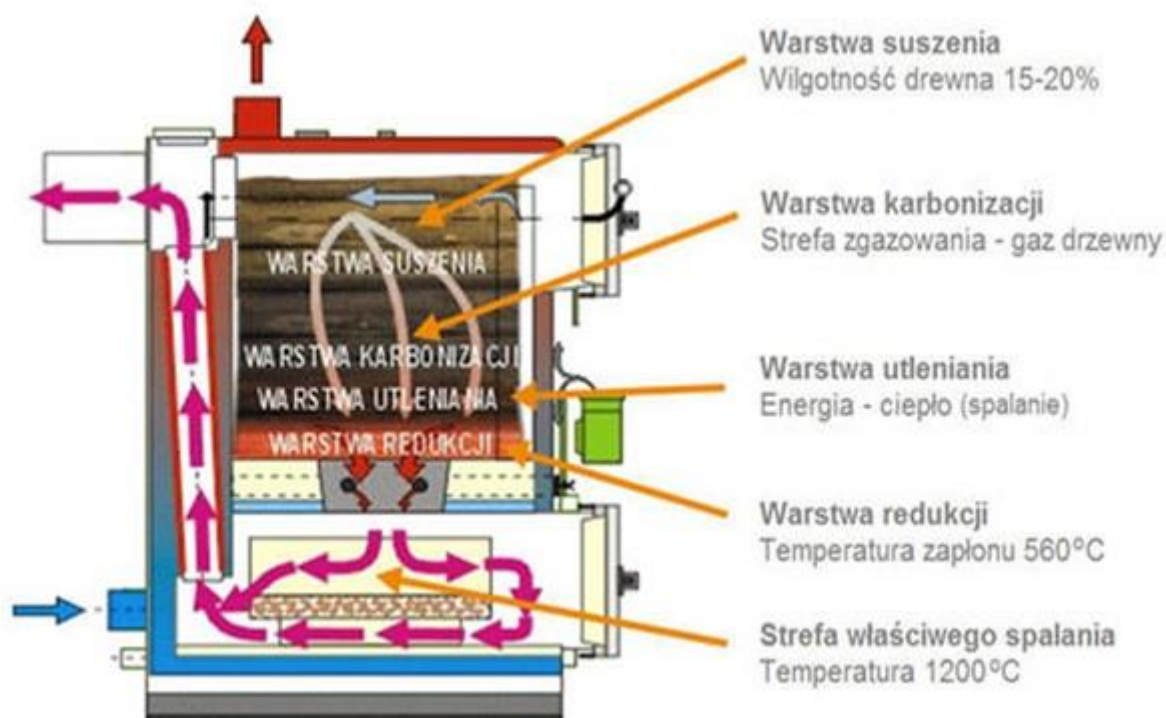
Ryc. 19. Schemat spalania drewna w kotle zgazowującym
