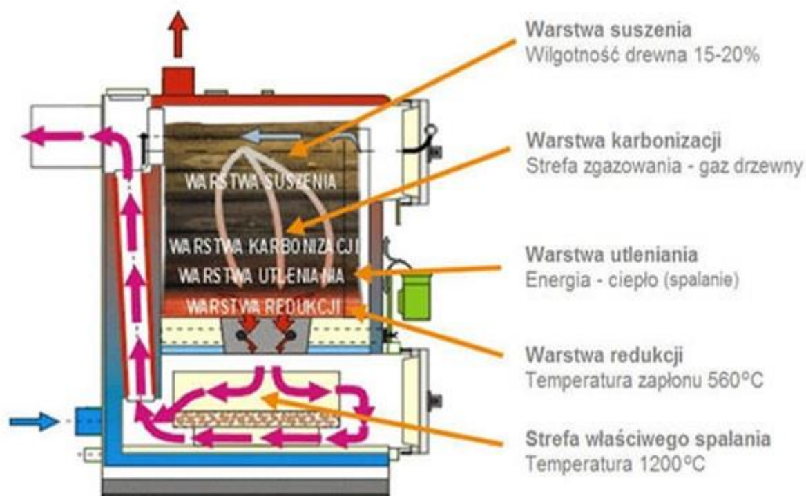
Ryc. 19. Schemat spalania drewna w kotle zgazowującym
